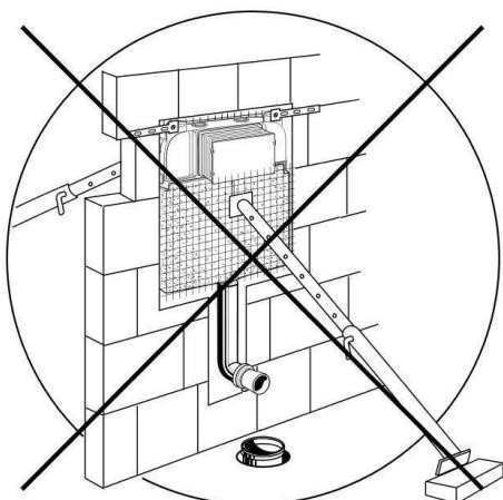
Non utilizzare puntelli o altri elementi per il sostegno verticale della struttura.
