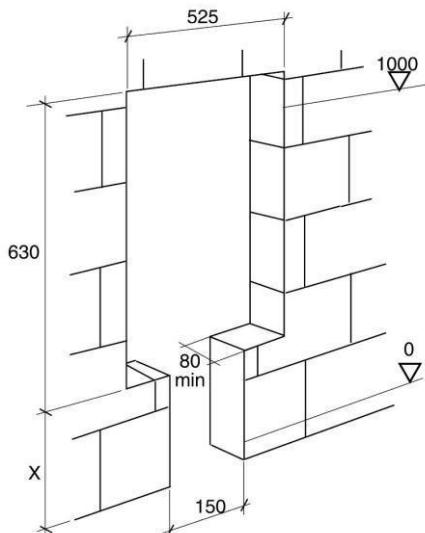
Può essere installata all'interno di pareti in muratura di spessore min 80,mm.
