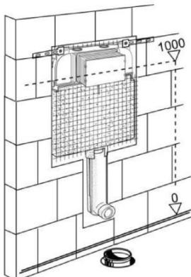
La corretta posizione della cassetta si ottiene quando il livello del metro coincide con il centro della scatola di protezione come mostrato in figura.
