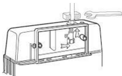
Collegare la rete idrica utilizzando la spugnetta in dotazione per evitare che penetrino
