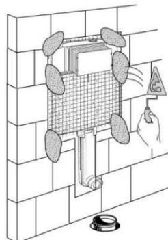
Per una corretta installazione si deve posizionare la cassetta WALL all'interno del muro utilizzando le protezioni in dotazione. Utilizzare le squadrette metalliche per ancorare la cassetta parallela al piano del muro. La cassetta è dotata di una rete in fibra di vetro per garantire una maggiore aderenza all'intonaco, evitando così micro fessure nella superficie della parete.
